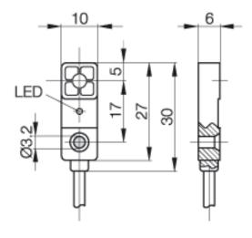
Induktiver Näherungsschalter BES R03KC-PSC30B-EP05 30 x 10 x 6 Schließer Sn=3mm bündig einbaubar
